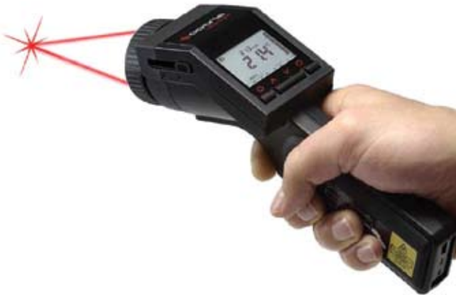
Slika 6: Infrardeči termometer, ki iz bližine lahko meri temperaturo na površini premera samo 1 mm in je pri preverjanju popravila lahko nadomestilo za termografsko kamero.
