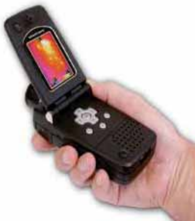
Slika 3: Nizkoresolucijska termografska kamera. Resolucija 120x120 točk znatno zmanjšuje ceno kamer in je trenutno trend proizvajalcev.
